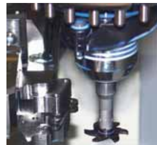
Bild oben: Mit dem Nutfräser 636 werden die Nuten in die beiden Maulteile gefräst.
